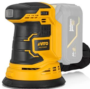
Lijadora orbital sin fios con una tensión nominal de 20V DC, tiene una velocidad de rotación en vacío de 2000-10000rpm, tiene una área de lijado de 125mm con una amplitud de oscilación de 2mm, tiene un nivel de potencia sonora de 98,1dB.
