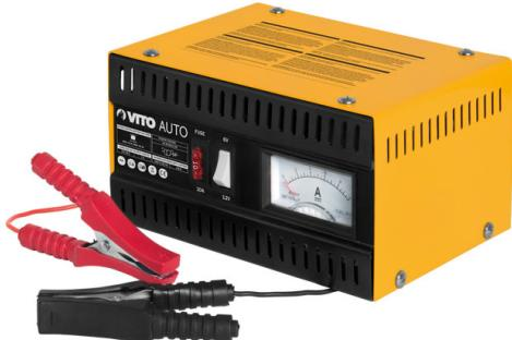
Carregador de Bateria portátil, com uma função de carga rápida, equipado com proteção contra inversão de polaridade e sobrecargas, possui uma tensão de carga de 6 - 12 V e uma tensão de alimentação de 220 V - 50 Hz, com capacidade de carregamento de 20 - 75 Ah, tem uma corrente de carga máxima de 10 A, conta ainda com uma potência máxima de 140W e um índice de proteção IP20.
