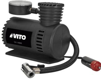
Der tragbare Minikompressor VITO (VICO12VA) mit einem Druck von bis zu 150 PSI - 10,3 bar eignet sich unter anderem zum Aufpumpen und Prüfen des Reifendrucks von Autos, Motorrädern, Fahrrädern. Dieser 12V-Kompressor lässt sich kompakt im Handschuhfach oder sogar im Kofferraum platzsparend verstauen und ist dennoch für alle Eventualitäten gerüstet. Dieses Modell hat eine Förderleistung von 15 Liter/Minute und auch ein Stromkabel mit 2,8 m.
