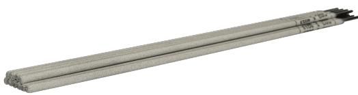
Ce jeu d'électrodes en acier inoxydable 308L-16 est conçu pour le soudage d'aciers inox austénitiques, offrant une excellente résistance à la corrosion et un arc particulièrement stable. Idéal pour tuyauterie, structures inox, équipements alimentaires et environnements exigeants. Compatibles avec le courant AC/DC (-), ils assurent une fusion régulière, peu de projections et des cordons propres. La scorie est facilement détachable, permettant un travail rapide et soigné.
