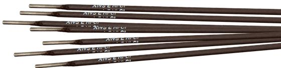
Ce jeu d'électrodes pour fonte, composé à 98% de nickel, assure une soudure ductile et résistante aux fissures, parfaite pour la réparation de pièces en fonte. Compatibles avec AC/DC (-), ils garantissent un arc stable et une mise à l'amorçage facile. Conformes à la norme AWS E Ni-CI, ils conviennent à la fonte grise, nodulaire et malléable. Avec une dureté de 160 HB, le dépôt de soudure absorbe bien les vibrations et les variations thermiques.
