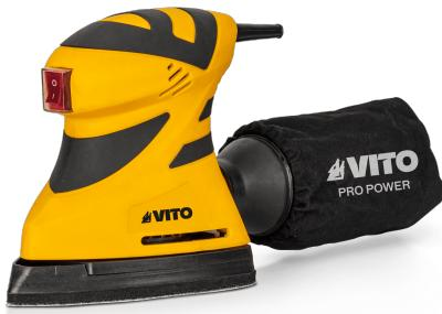
Lixadora Multibases com uma potência de 180W, tem uma tensão de alimentação de 230 V 50 Hz, possui uma velocidade de rotação de 12000rpm, tem uma velocidade de oscilação de 12000 - 22000opm e uma amplitude de oscilação de 1.8mm, inclui 2 bases oscilantes (triangular+quadrada).
