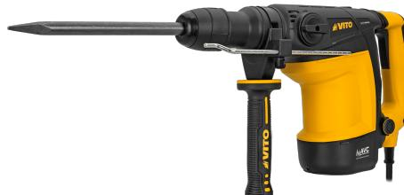
Martillo Perforador Demoledor con una potencia nominal de 1100W, Energía de impacto 1-7 J, Velocidad de rotación en vacío 300-760 rpm, frecuencia de impacto 1950-4680 ipm, tiene un portabrocas SDS-Max, 2 funciones, para realizar todas sus actividades con calidad.
