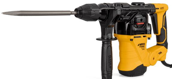
El martillo perforador/demoledor de 1250 W de VITO (VIMPDP1250) dispone de cuatro funciones: perforación, perforación con percusión (albañilería), demolición (cincelado) y ajuste de la posición del cincel. Además del portabrocas de sujeción rápida SDS-plus e y velocidad variable. El martillo perforador/demoledor tiene un tope de profundidad y una empuñadura auxiliar para mayor ergonomía y comodidad.
