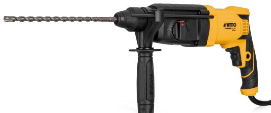
En plus du mandrin à serrage rapide SDS-plus, cette machine dispose également d'un sens de rotation réversible droite/gauche et d'une vitesse variable. Le marteau perforateur/burineur dispose d'une butée de profondeur et d'une poignée auxiliaire pour une meilleure ergonomie et un plus grand confort.
