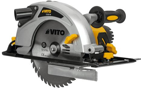
La sierra circular de 2100W tiene vacío 4500rpm, un disco de 24 dientes con 235mm de diámetro, un diámetro de agujero del disco de 30mm, un grosor del disco de 1,6mm, para ayudarle a hacer todos sus trabajos de forma segura y eficiente.
