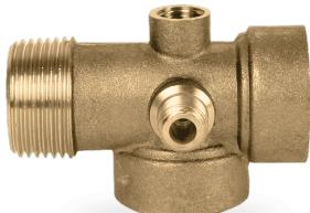
Esta conexión de 5 salidas con entradas/salidas de 1/2" y 1.1/4" es una solución versátil para sistemas que requieren múltiples conexiones. Ideal para distribuir el flujo en hasta cinco direcciones, se utiliza ampliamente en sistemas hidráulicos de alta eficiencia, como redes de riego, abastecimiento de agua y aplicaciones industriales. Con una construcción robusta (en latón) y excelente resistencia a la presión, este "T" garantiza durabilidad y un rendimiento confiable en diversas condiciones.
