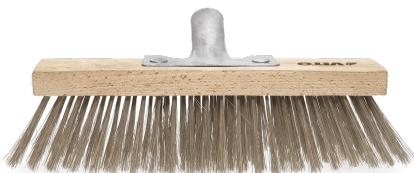
Escoba de Acero Reforzado con cerdas de 7cm en acero latonado reforzado y filas de 6 x 22 con 50 hilos cada.
